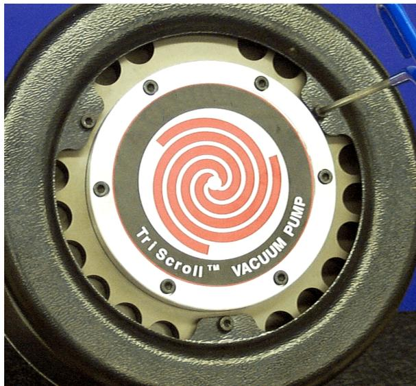
1. Déposer les trois vis M5x16 fixant le cache au module.
