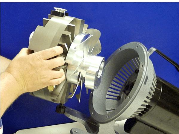
5. Poser le module de pompe sur le cadre, en alignant les doigts du ventilateur avec les doigts de l'accouplement. Veiller à la pose correcte des goupilles de positionnement sur les orifices dans le cadre.
